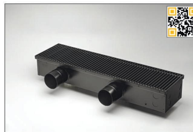
Гольфстрим КПК – внутрипольный конвектор с подводом приточного воздуха от системы вентиляции. За счет своего принципа действия, помимо обогрева, прибор также обеспечивает приток свежего воздуха в помещение. Его подача на теплообменник конвектора регулируется шиберной заслонкой.
