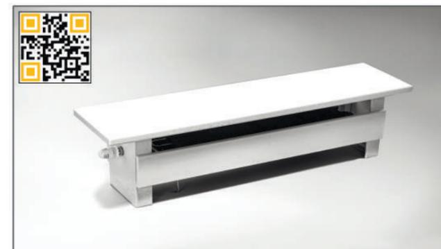
**Фасадный конвектор** - применяется для отопления помещений с многоуровневым витражным остеклением большой площади высотой от 4-х метров. Конвекторы устанавливаются на вертикальные рамы или горизонтальные ригели оконных конструкций в один или несколько ярусов. Возможны варианты исполнения прибора с отсеком для труб и без отсека.
